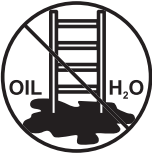
Upewnić się, że podłoże jest wolne od zanieczyszczeń Ensure ground is free from contaminants
