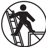
Nie schodzić z boku drabiny Do not descend on the side of a ladder
