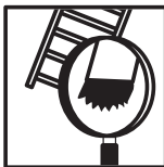
Sprawdzić stopki drabiny Inspect ladder feet
