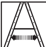
Upewnić się, że drabina została w pełni otwarta przed użyciem Before use ensure that ladder was fully opened
