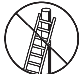
Upewnić się, że wierzchołek drabiny jest ustawiony właściwie Ensure top of ladder is correctly positioned
