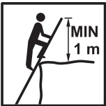
Wierzchołek drabiny powyżej punktu oparcia Top of ladder above the landing point
